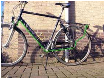
Afbeelding 5: het trekken van een nieuwe draad in plaats van de draad die voor een groot deel door de framebuizen loopt. De draad loopt nu aan de buitenkant langs de framebuizen (in groen zichtbaar op kleurenkopie).
